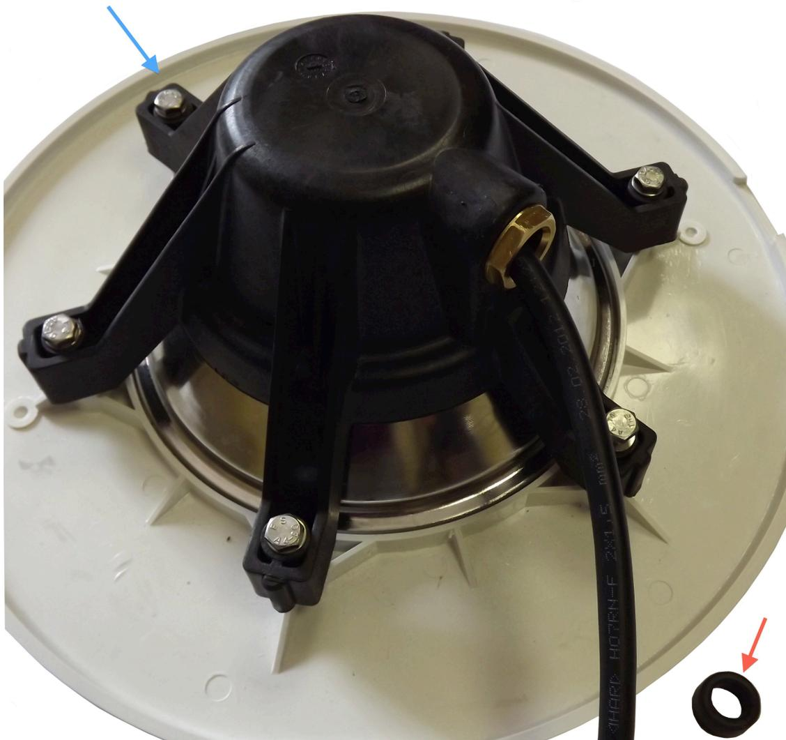
**ATTENTION !** Avec la lampe à LED PAR56 avec son câble déjà connecté au corps, la connexion est étanche et donc le presse-étoupe et/ou le joint d'étanchéité indiqués par la flèche rouge **NE DOIVENT PAS** être fermés ou montés. De cette façon l'eau peut refroidir ultérieurement la lampe ; on recommande de ne pas serrer excessivement les vis indiquées par la flèche bleue parce que on risque de déformer la mécanique de la lampe. Serrez le minimum nécessaire pour maintenir la lampe en position.
